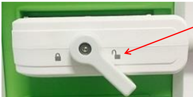
29. ábra: A transzducercsatlakozó rögzítőgombja kioldva
